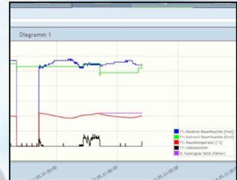
Das Remoteportal ermöglicht die kontinuierliche Aufzeichnung von wichtigen Betriebsdaten des Luftbe- und Entfeuchtungssystems. Dazu gehören Parameter wie Luftfeuchtigkeit, Temperatur (B 600), Leistungsdaten und andere relevante Informationen. Diese Aufzeichnungen können für spätere Analysen, Berichte oder zur Überwachung des Systemverhaltens genutzt werden.
