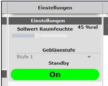
Benutzer haben die Möglichkeit, die gewünschte Sollfeuchte für das Luftbefeuchtungssystem über das Remoteportal einzustellen. Dies ermöglicht eine präzise Steuerung und Anpassung der Luftfeuchtigkeit entsprechend den individuellen Anforderungen oder den spezifischen Bedingungen des Raums oder Gebäudes.
