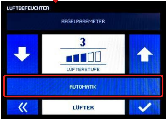
Fig. 5.5.2: Setting the fan speed
