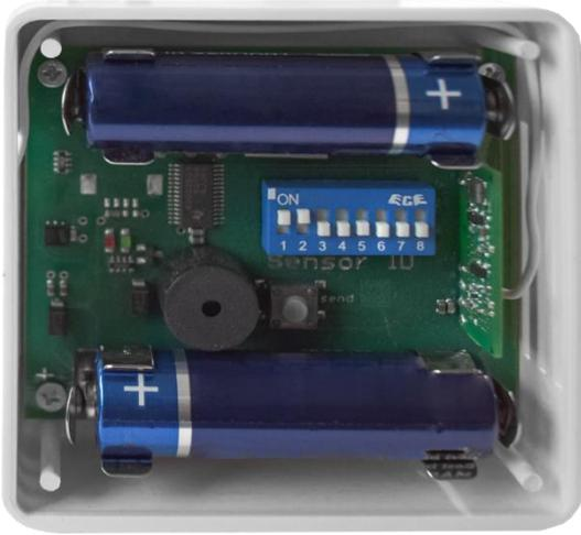
Fig. 3.4.2: Insert batteries
