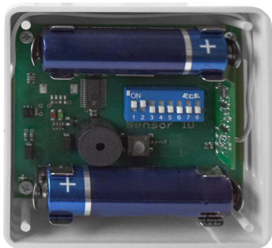
Fig. 3.5.1: Coding switch for coding
