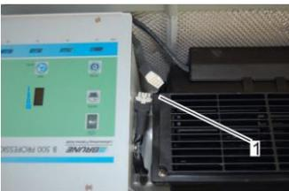
Fig. 52: Removing the fan plug
